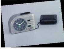
Un flash lumineux ou une vibration sont délivrés au déclenchement du bruit.
